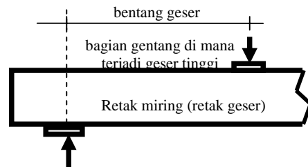
Gambar 2. Retak miring pada balok beton bertulang
