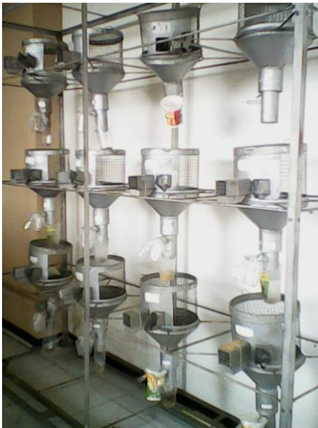
Gambar alat diuresis dan pengujian kimia urin
