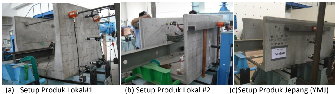
Gambar 5. Photo Setup Pengujian masing-masing Benda Uji
