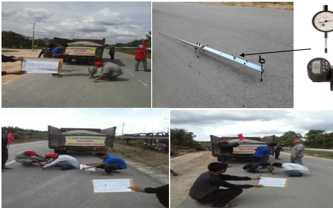
Gambar 2. Pengujian lendutan balik dengan alat Benkleman Beam dan detailnya.
