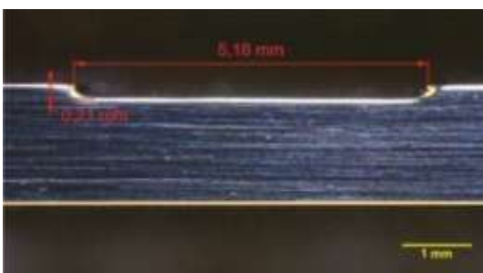
Gambar 7. Foto mikro profil dinding bawah dengan arus 0.15 A
