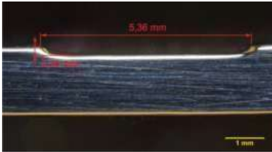
Gambar 8. Foto mikro profil dinding bawah dengan arus 0.3 A
