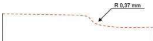
Gambar 13. Foto mikro profil dinding samping dengan arus 0.15 A
