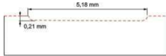
Gambar 8. Foto mikro profil dinding bawah dengan arus 0.3 A
