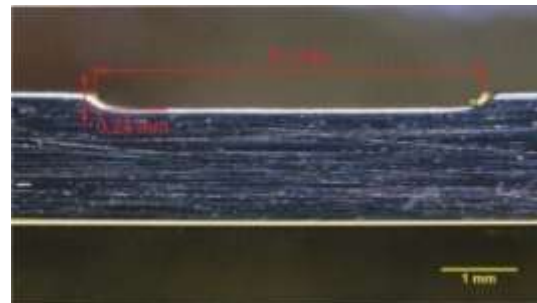
Gambar 6. Foto mikro profil dinding bawah dengan arus 0.12 A
