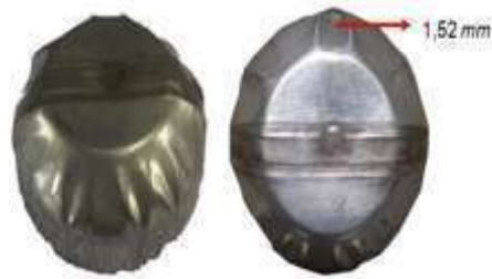
Gambar 9. Hasil pengujian cup drawing sambungan las titik.
