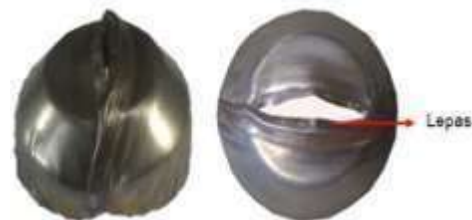
Gambar 11. Hasil pengujian cup drawing sambungan tekuk
