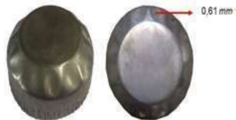
Gambar 10. Hasil pengujian cup drawing tanpa sambungan.
