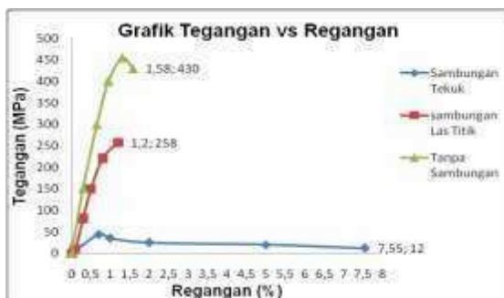
Gambar 8. Perbandingan tegangan-regangan untuk semua spesimen.
