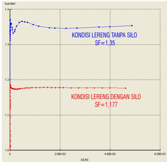
**Gambar 7.** Perbandingan faktor aman (SF) untuk kondisi lereng terbebani dan tidak terbebani silo.
