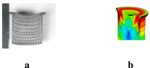
Gambar 2. Pola aliran dan bentuk cacat rongga (a) Hasil eksperimen, (b) Hasil simulasi.
