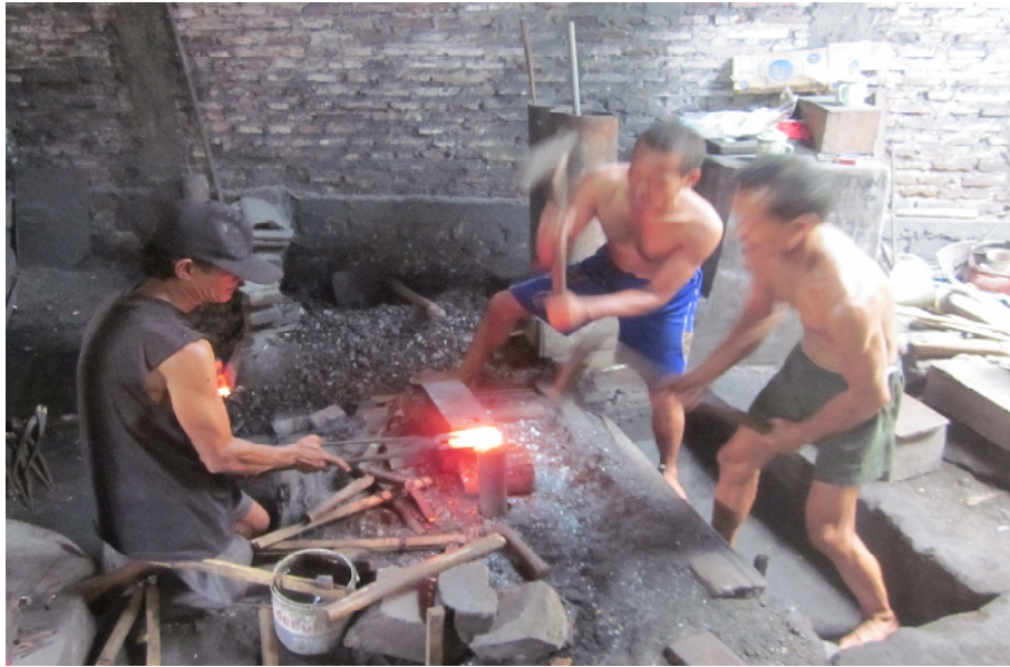
Gambar 2. Proses pembuatan alat pertanian di Kelompok Pande Besi “PRT”
