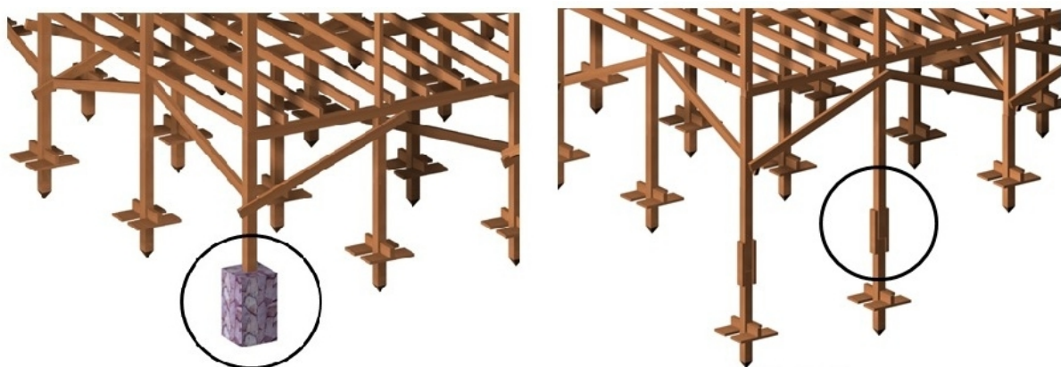
Gambar 5. Dudukan pondasi batu (kiri) dan sambungan trucuk ulin (kanan)
