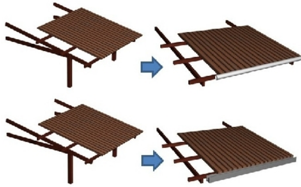
Gambar 6. Pemasangan talang pipa (kanan)
