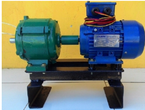
Gambar 3 Koneksi penggerak mula ke poros rotor alternator
