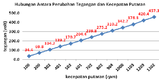
Gambar 7 Kurva hubungan perubahan tegangan terminal alternator sebagai fungsi perubahan kecepatan putaran poros rotor
