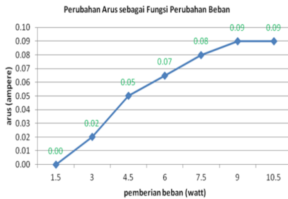
Gambar 11 Kurva hubungan perubahan arus sebagai fungsi perubahan pemberian beban
