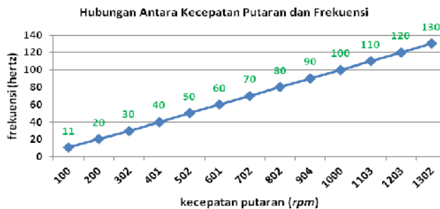
Gambar 8 Kurva hubungan perubahan frekuensi sebagai fungsi perubahan kecepatan putaran poros rotor
