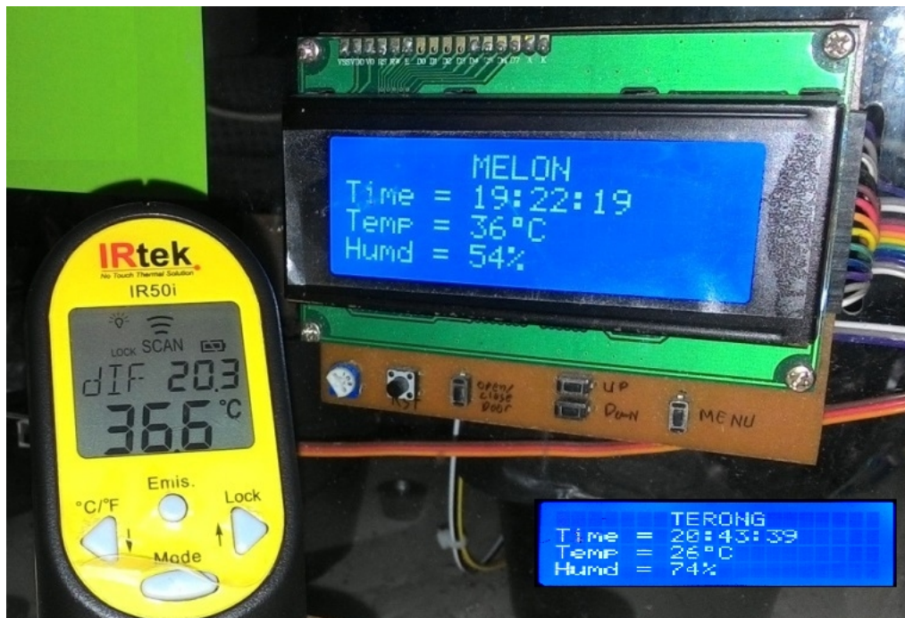
Gambar 6. Pengukuran kinerja sistem untuk pantauan suhu dan kelembaban dalam ruangan
