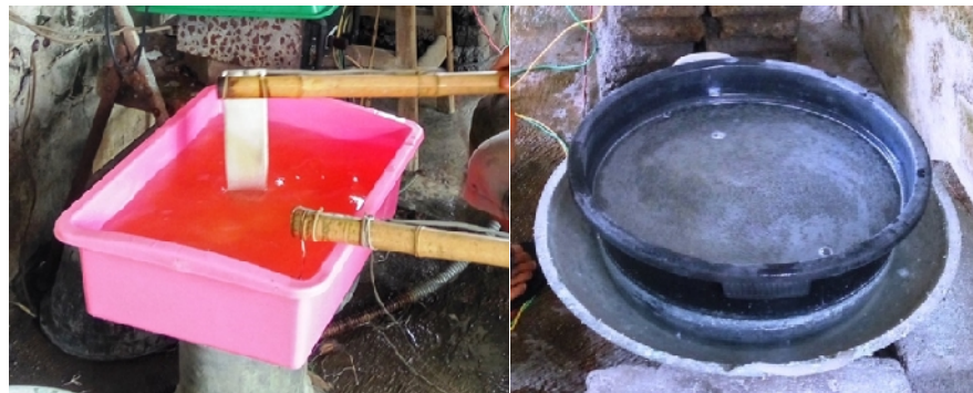
Gambar 4.Reaktor/Sel elektrokimia penyepuhan perak oleh UMKM
