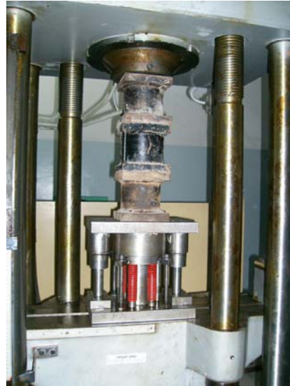
Gambar 3. Proses penekanan dengan compression machine
