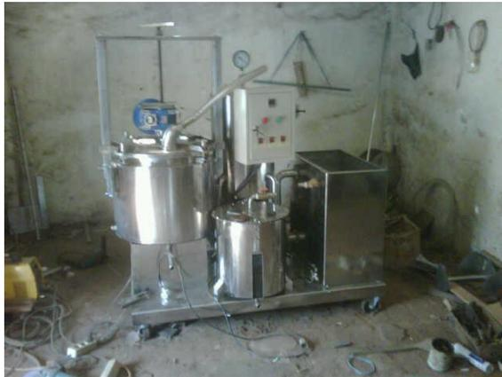
**Gambar 5. Hasil Rancangan Mesin Vacum Evaporator**
