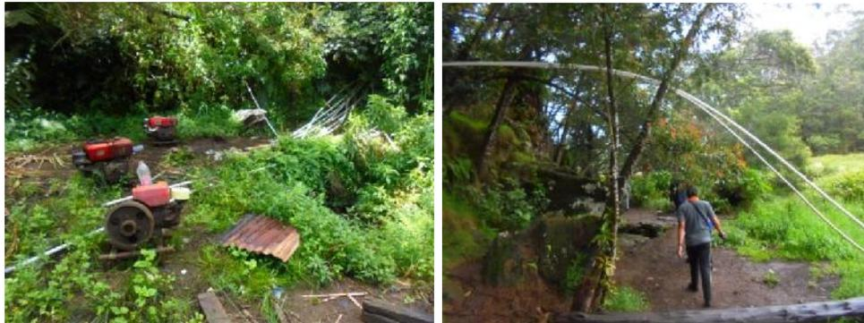
**Gambar 6 & 7.** Mesin pompa air dan pralon saat aktivitas penyedotan air dari Telaga Pengilon untuk usahatani kentang (Sumber: C.Yudi, 2016)
