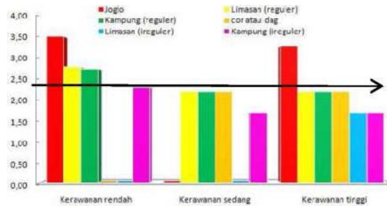
Gambar 2. Tingkat Kerentanan Bangunan berdasarkan atap bangunan.
