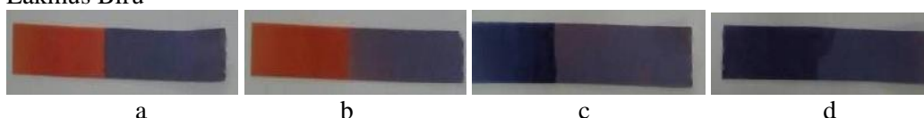
Gambar 3.2.3. Perbandingan hasil pengujian kertas indikator asam basa dari ekstrak daun Rhoeo discolor dengan kertas lakmus merah dan biru; (a) larutan asam kuat (HCl), (b) larutan asam lemah (CH 3 COOH), (c) larutan basa kuat (NaOH), (d) larutan basa lemah (NH 4 OH).
