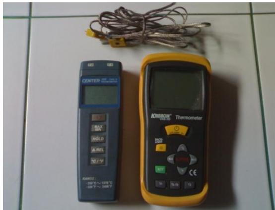
Gambar 3.16 *Thermochouple dan Thermocouple Reader*
