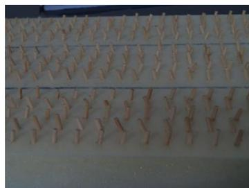
Gambar 3. a. Penyisipan *z-pin* ke dalam *polyurethane rigid foam*
