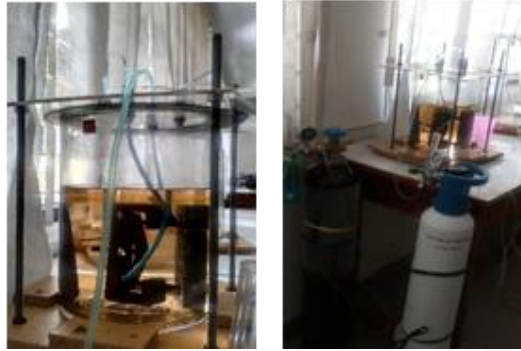
Gambar 3. Chamber uji korosi. (tabung berwarna putih berisi gas H 2 S dan tabung berwarna hitam berisi CO 2 ).
