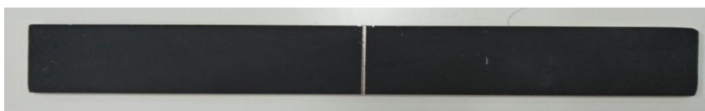
Gambar 2. Sampel uji korosi pelat API 5L-X65 diberi crack awalnya.
