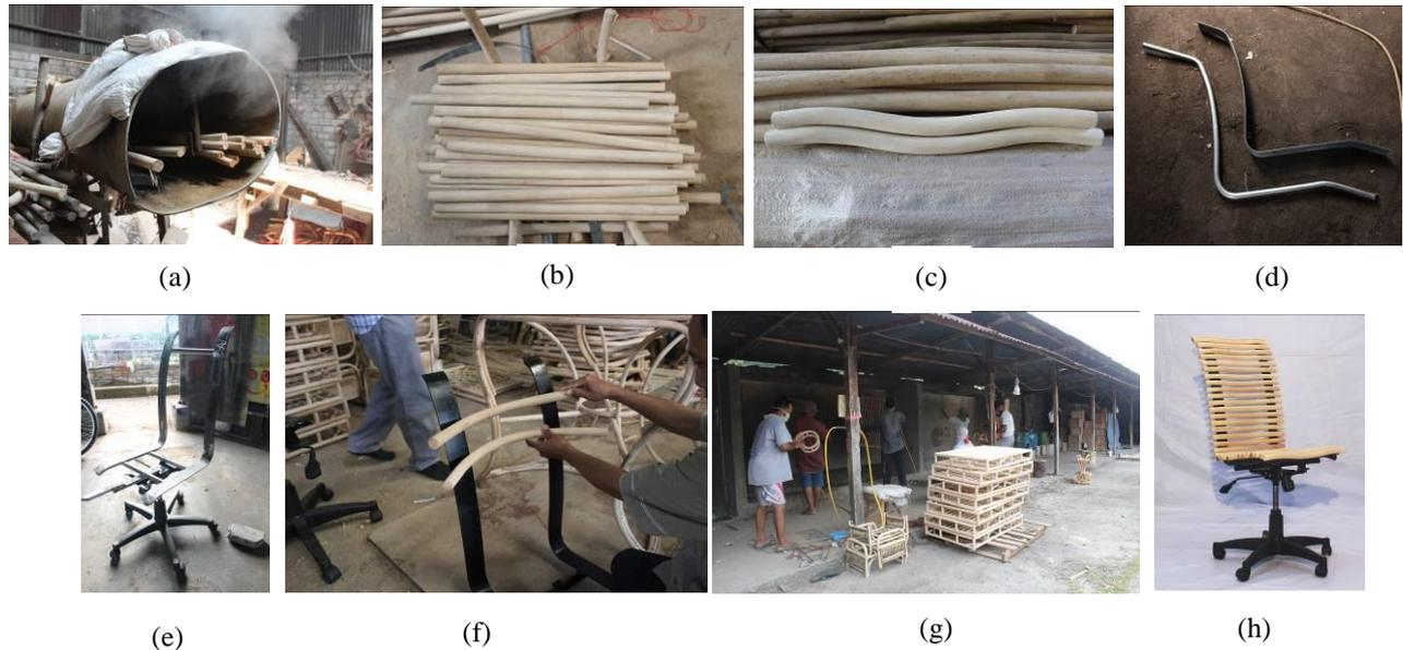
Gambar 10. Alur proses produksi kursi, (a) Proses steam, (b) Proses potong, (c) Proses *bending*, (d) Proses *bending* besi, (e) Proses *assembling* besi, (f) Proses *assembling* rotan, (g) Proses *finishing*, (h) Produk kursi kerja rotan. (foto: dokumentasi penulis)
