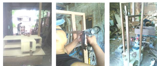
Gambar 15. Proses perakitan produk (a) perangkaian bagian rak bawah, (b) perangkaian rangka utama material balok kayu kelapa, (c) Hasil akhir rangka utama bentuk desain. (Sumber: penulis, 2016)
