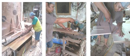
Gambar 14. Proses pemotongan komponen (a) proses pemotongan bahan baku utama menjadi balok dan meratakan permukaan, (b)(c) proses pemotongan material sesuai bentuk dan ukuran desain. (Sumber: penulis, 2016)
