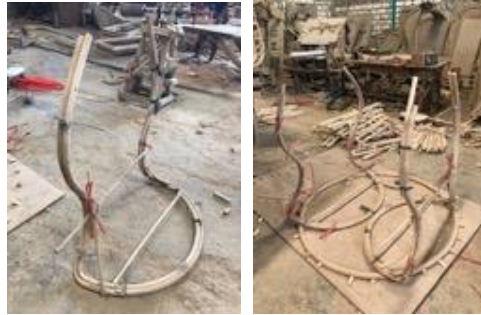
Gambar 9. Proses adjusting meja Pukung bagian kaki meja (Foto: dokumentasi penulis, 2017)
