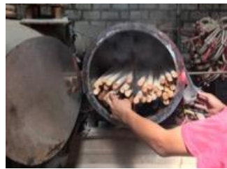
Gambar 7. Proses pemanasan rotan dengan alat sederhana dan sumber pembakarannya berasal dari limbah rotan (Foto: dokumentasi penulis, 2017)
