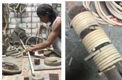
Gambar 8. Proses tekuk rotan yang hanya dilakukan oleh pekerja laki-laki dan beberapa dibantu alat pemutar (Foto: dokumentasi penulis, 2017)
