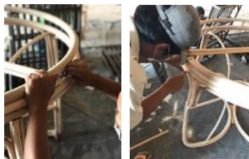
Gambar 11. Proses perakitan meja Pukung (Foto: dokumentasi penulis, 2017)
