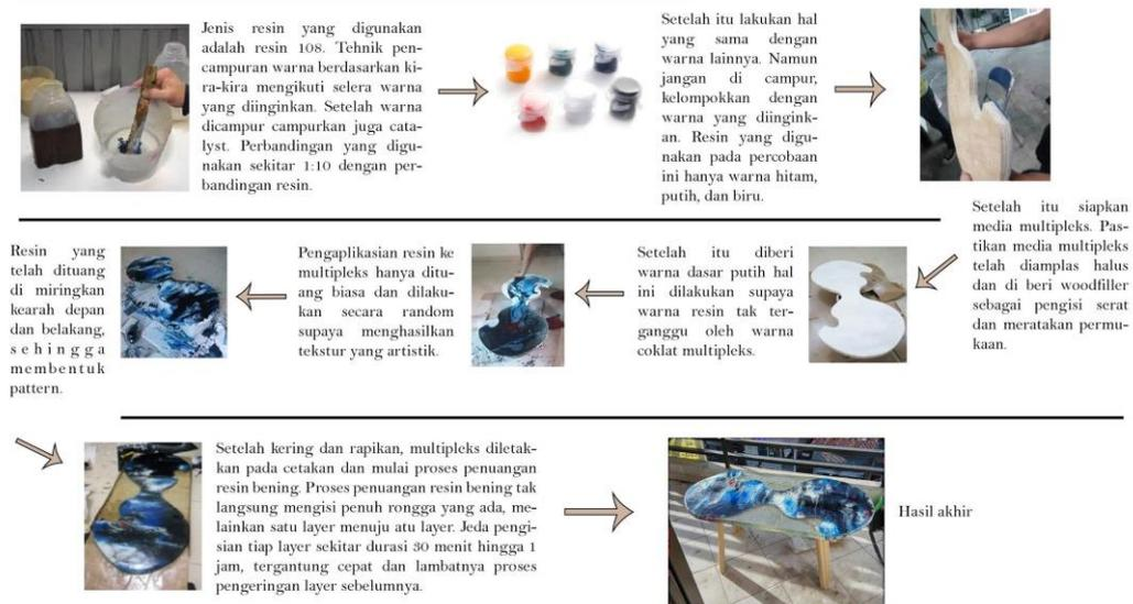
Gambar 4. Proses pembuatan meja resin
