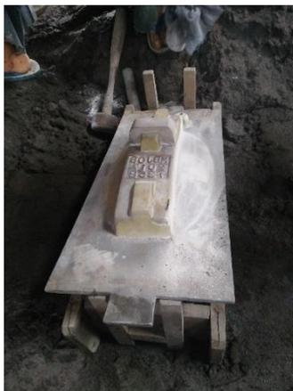
**Gambar 1. Pola Cetakan Blok Rem T.358**
