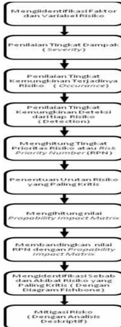
Gambar Diagram Alur penelitian dengan analisis *Failure Mode and Effect Analysis* (FMEA)
